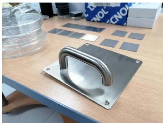
**Muestra de manivela objeto de ensayo**
